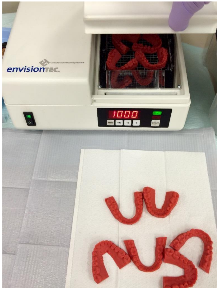
Modelle, die aus Ortho Tough auf einem EnvisionTEC Perfactory Vida gedruckt und gehärtet wurden.
