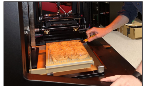
Dentalmodelle können flach auf der Vector 3SP gedruckt werden. Diese sind anschließend leicht zu entfernen (unten).
