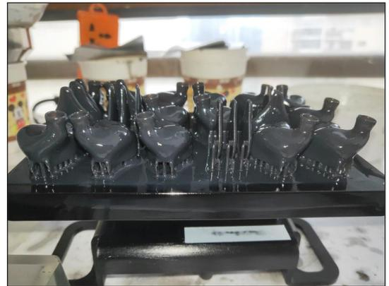
Die große Bauplattform der Micro Plus XL ermöglicht die Fertigung von 7 Ohrmuscheln in einem einzigen Druck. Vertikale oder horizontale Ausrichtung maximiert zudem den Ertrag.
