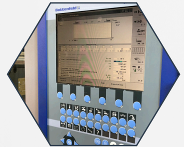
Konfiguration der individuellen Parameter, je nach zu verspritzendem Kunststoff und temperaturkontrolle bei Spritzverfahren.
